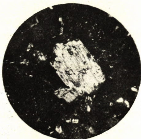
Obr. 4. Serpentinizácia rombického pyroxénu — hypersténu postupujúca od okrajov a pozdĺž štiepatelnosti v pyroxenickom andezite z aglomerátov. Nik. +. Zväčšené.
